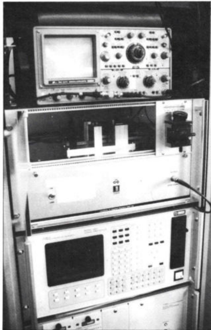
Bewakingsapparatuur voor de optische kwaliteitscontrole van grote constructies.
